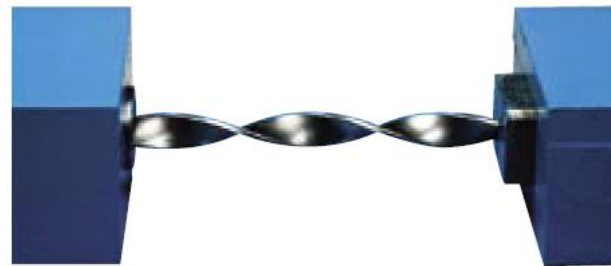
Skręcenie „paska” z żeliwa sferoidalnego.
