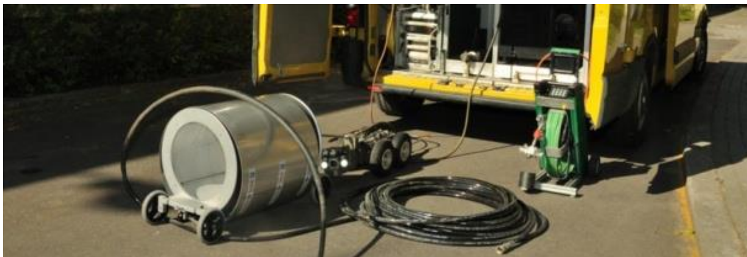
zamek rozpierający metalowy płaszcz uszczelniająco - wzmacniający
