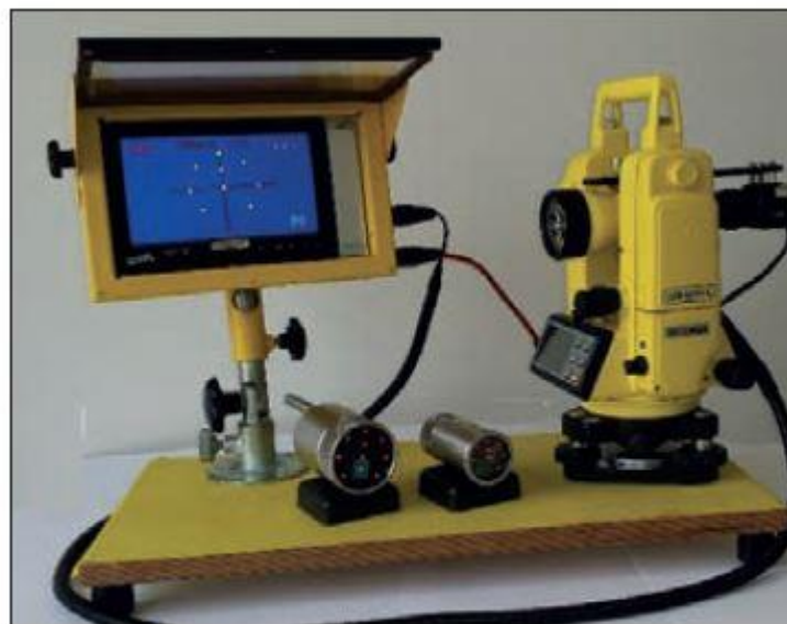
Rys. 8. Zestaw Nawigacji teleoptycznej TSP [6] Fig. 8. TSP teleoptic navigation kit
